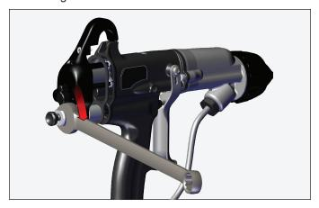
9. Install fan air valve cartridge.
